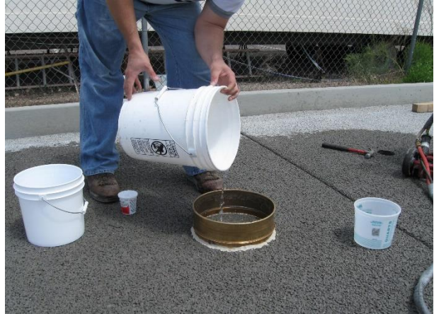
Obrázek 6 – test vodopropustnosti v terénu
