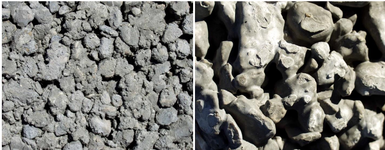
Obrázek 7. Srovnání nevhodného a správného vzhledu cementové pasty
