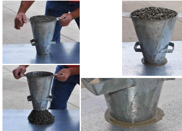
Obrázek 9. Test sednutí kužele. Vlevo správná konzistence, vpravo příliš mokrá.
