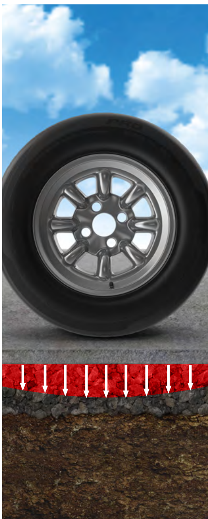
Nejlepší varianta rozložení napětí v betonové vozovce
